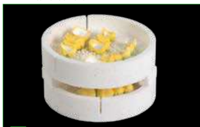
7 Egymásra helyezett MS égetőcsészek manuálisan színezett fogpótlásokkal.
