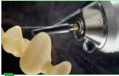
1 Megmunkálás vízhűtési turbinával.
