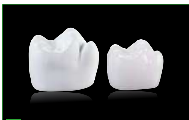
4 Órlófog szinterelés előtt és után; szinterelési zsugorodás kb. 20 százalék
