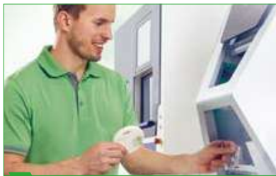
1 Példa a CAM-egység nyersdarabokkal való feltöltésére
