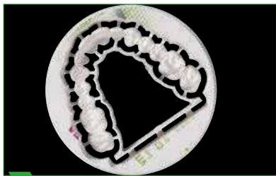
1 Hidak vázasított támasztó struktúrával a marás után.
