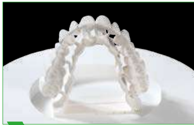
5 Leválasztott és átdolgozott fogpótlás a támasztó struktúrával.
