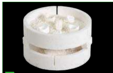
6 Color/Multicolor-fogpótlások szinterézése rakásolással.
